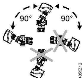
Термические приводы STA.., STP.. могут быть смонтированы в любом положении.
