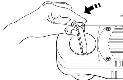
Отпускание клапана вручную
