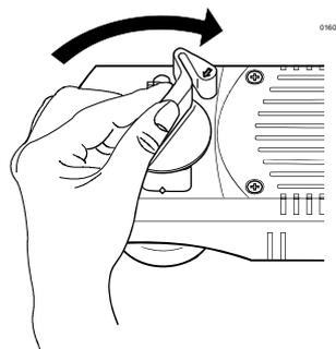
Поверните рычаг до механического упора и освободите.
