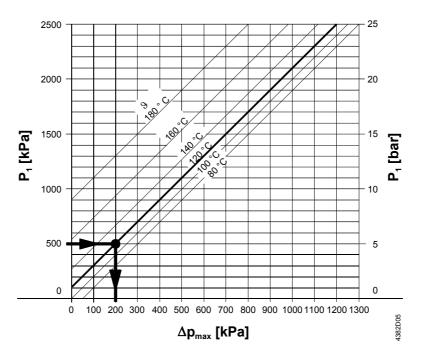
$\Delta p_{\text{max}}$  = перепад давления в почти закрытом клапане, при
