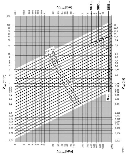
$\Delta p_{\text{max}}$  = максимальное допустимый перепад давления в клапане, распространяющийся на весь диапазон хода клапана с электроприводом
